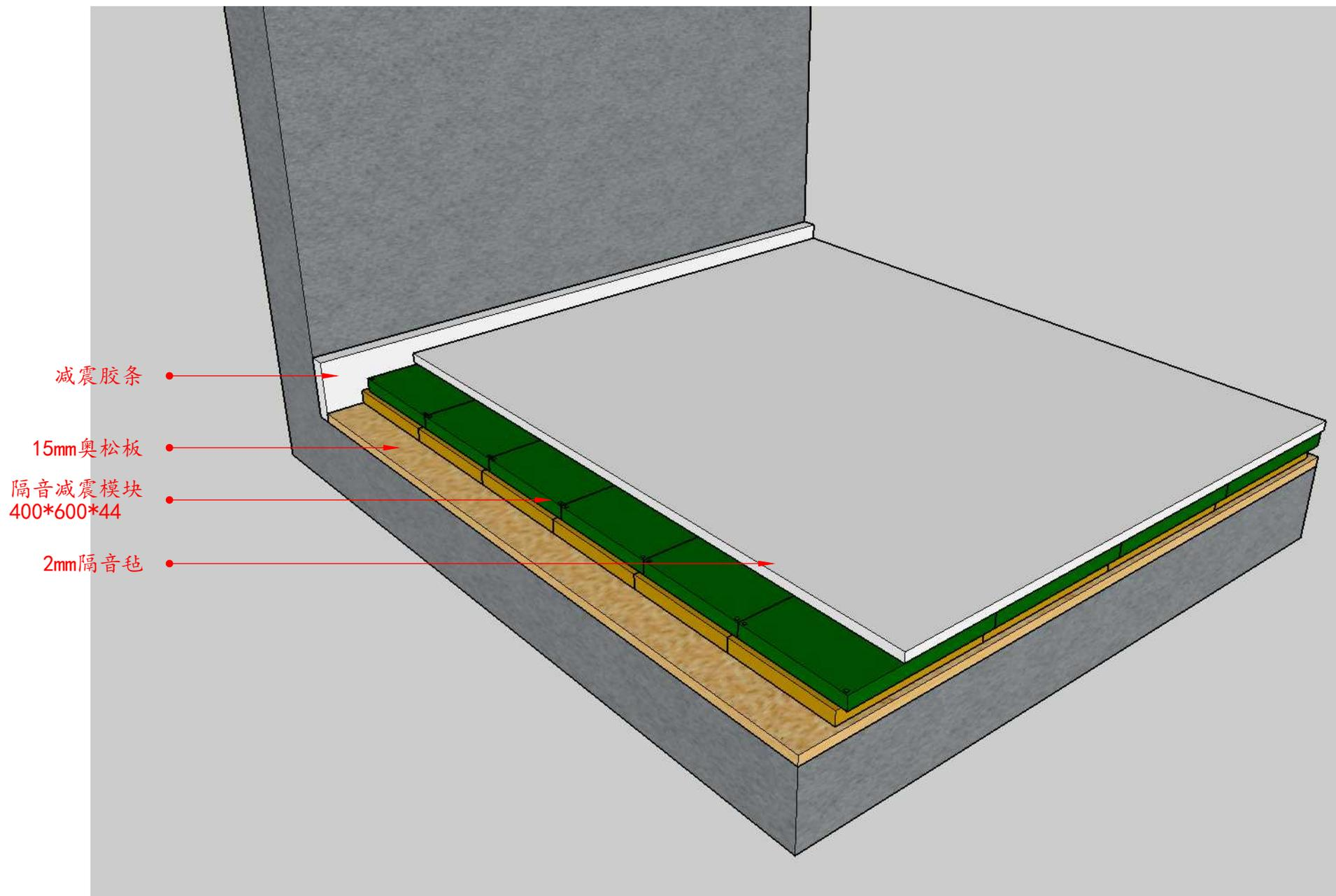
地面隔音结构示意图
