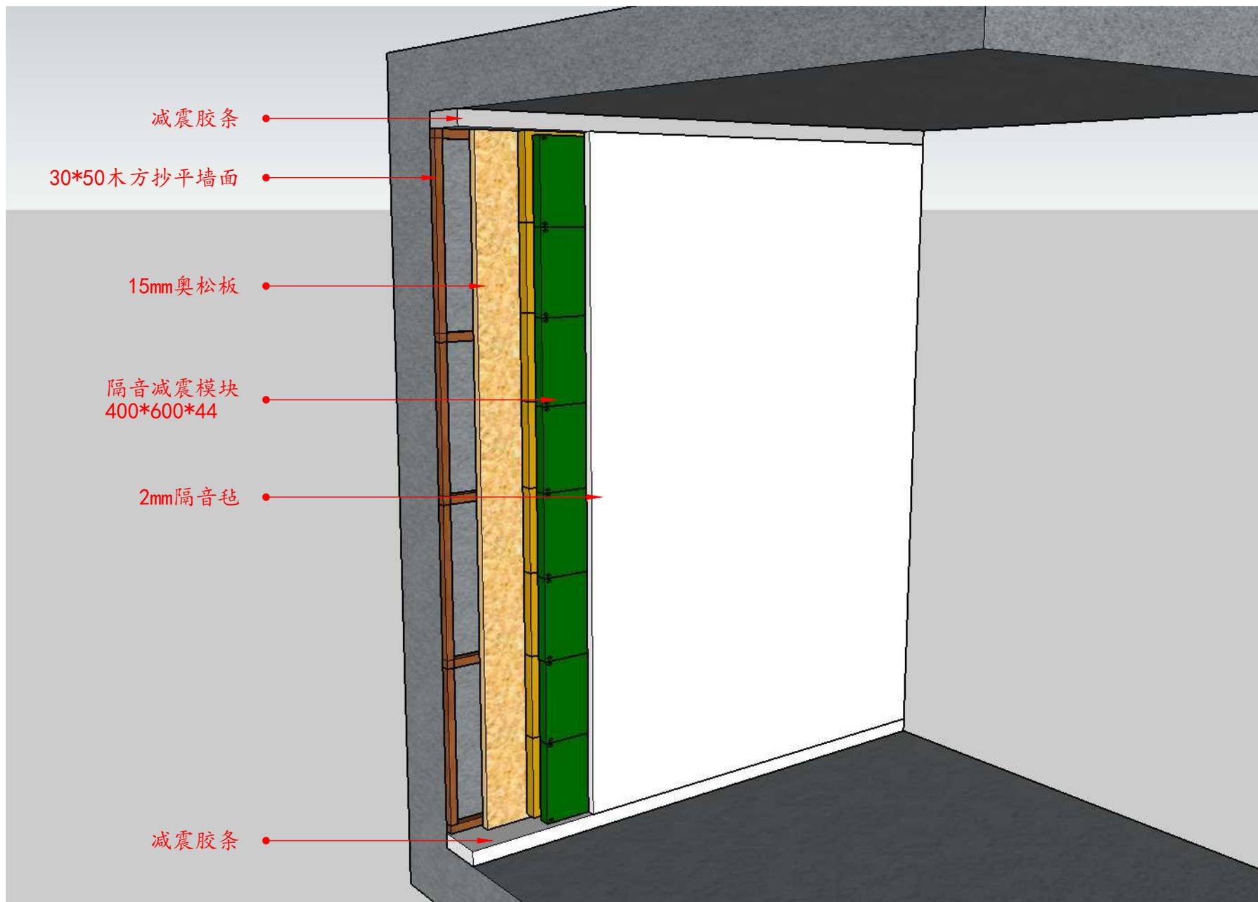
墙面隔音结构示意图
