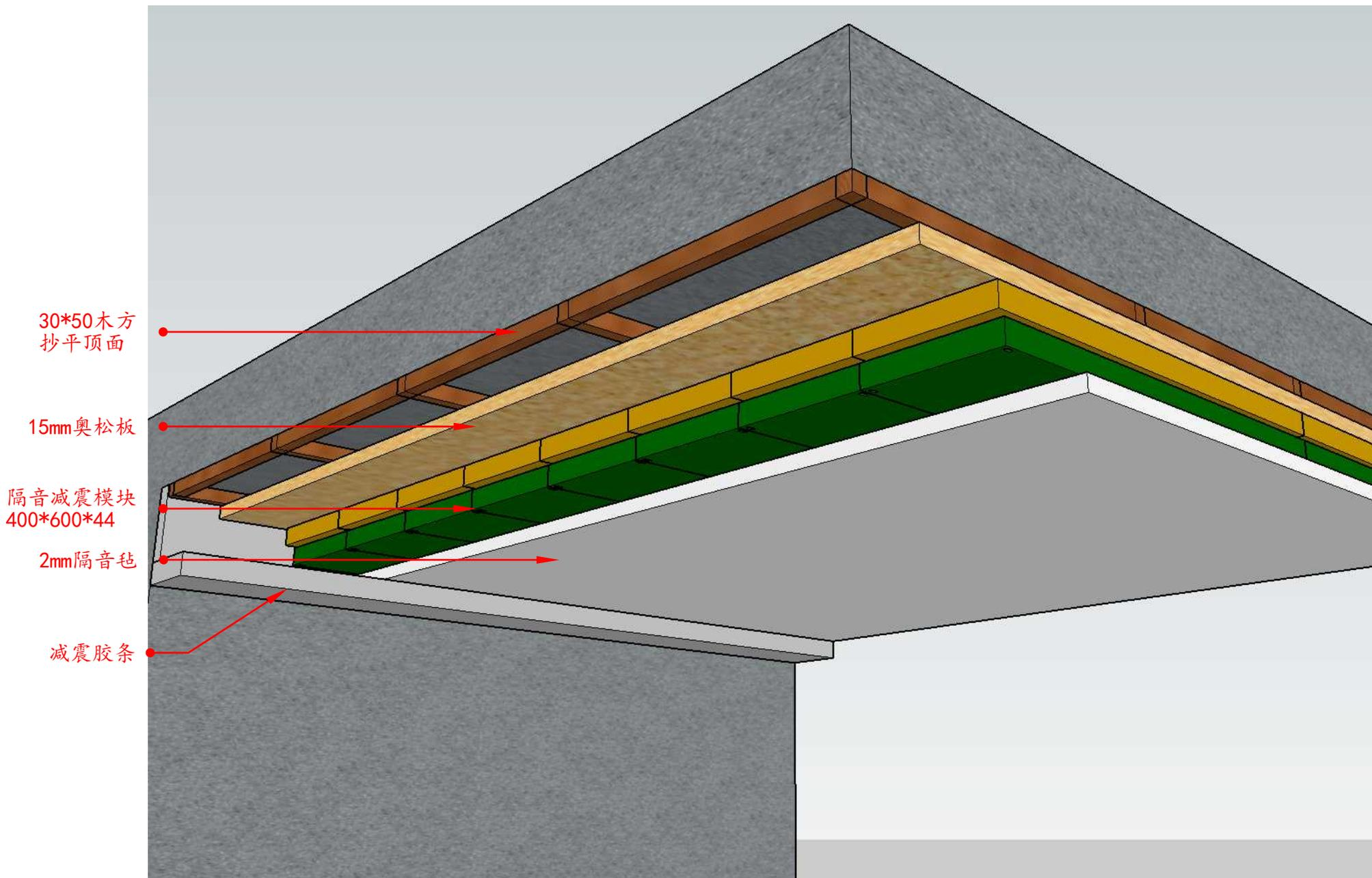
顶面隔音结构示意图
